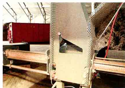
Die automatisch betätigte Guillotine zerteilt den Strang in 25 bis 50 cm lange Briketts.
