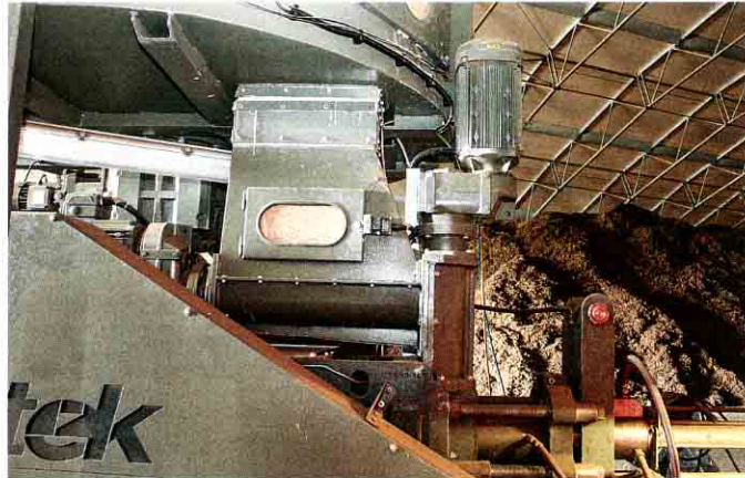
Das Material fällt aus dem Vorratsbehälter in einen Schacht mit Sichtfenster. Darunter dreht sich die Zuführschnecke. Die senkrechte Stopfschnecke fördert das Pressgut vor den Presskolben. Fotos: Böhrnsen, Herrmann (1), Werkbilder (2)
