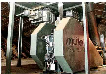
Zwei große Schwungräder beschleunigen den Presskolben. Ein 37-kW-Elektromotor treibt sie an.
