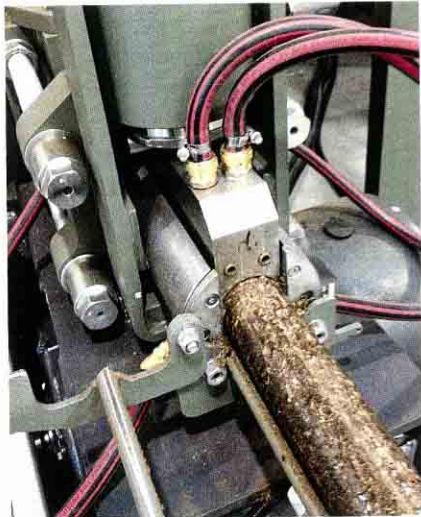
Die Presszange und des Pressrohr sind wassergekühlt. Über den hydraulischen Stempel kann Druck auf die Zange gegeben werden.
