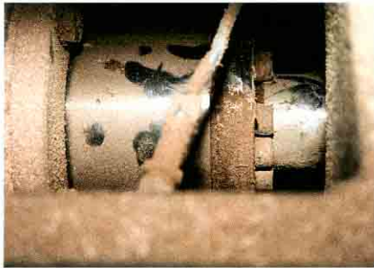
Der Presskolben aus gehärtetem Chromstahl ist auswechselbar.
