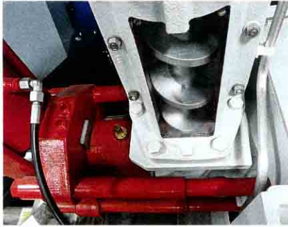
Die 400 mm lange Stopfschnecke hat oben einen Durchmesser von 100 mm und verjüngt sich nach unten auf 60 mm.
